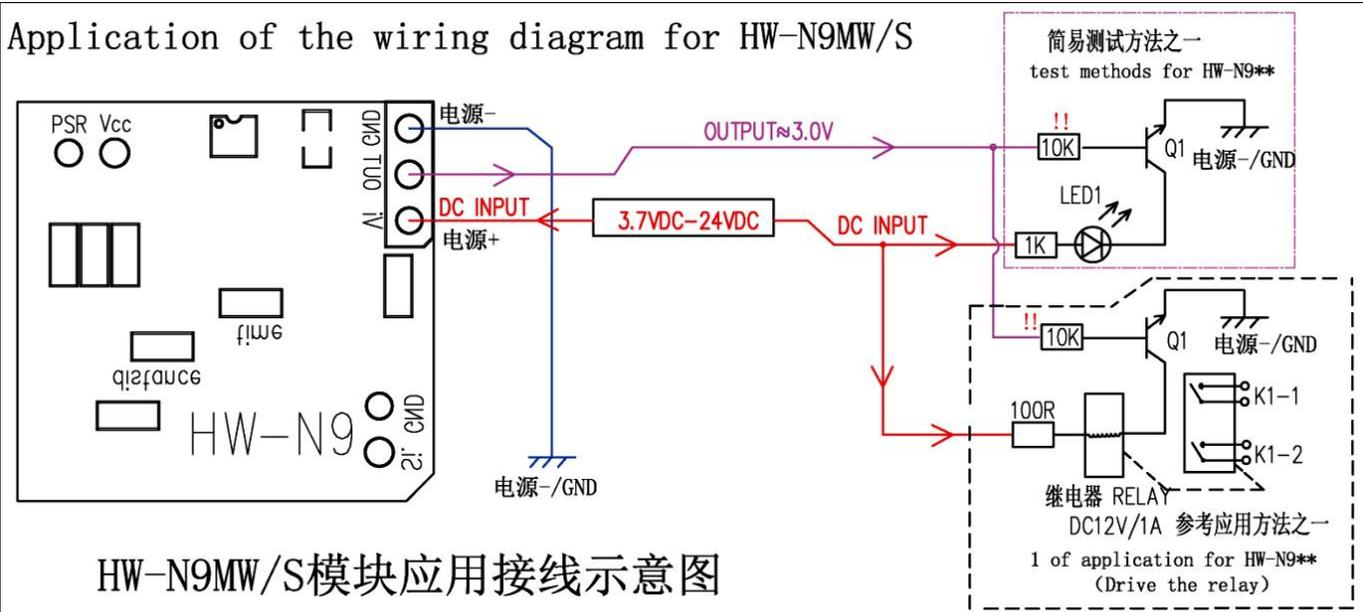
●如图所示，VCC 可供电 DC3.7-24V，JP 为 N9MW 输出端口，2 中间输出高电平信号，当 2 脚输出高电平时，NPN 管 8050 导通，VCC 将为 LED 供电，此时 LED 为亮态，表明模块有信号输出。当 2 脚无信号输出时，输出端为无信号状态 0V。如需检测本产品性能，可单独按照上图接线。
