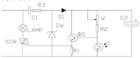
上图为光控路灯电路,白天路灯熄灭,夜间路灯自动点亮。图中,电容 C1、C2、R3 和二极管 D1 及稳压管 DW,组成简单的电容降压整流电路,接通电源后获得 12V 左右的直流电压。三极管 BG、环境光探测器 EKPD111A 和双向可控硅等,组成光电开关电路。
